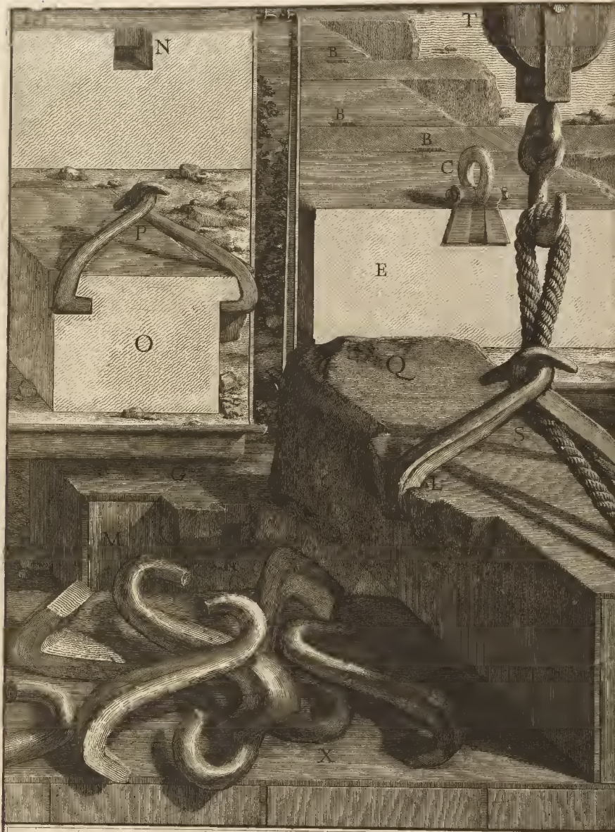
Modo, col quale furono alzati i grossi Travertini, e gli altri Marmi nel
