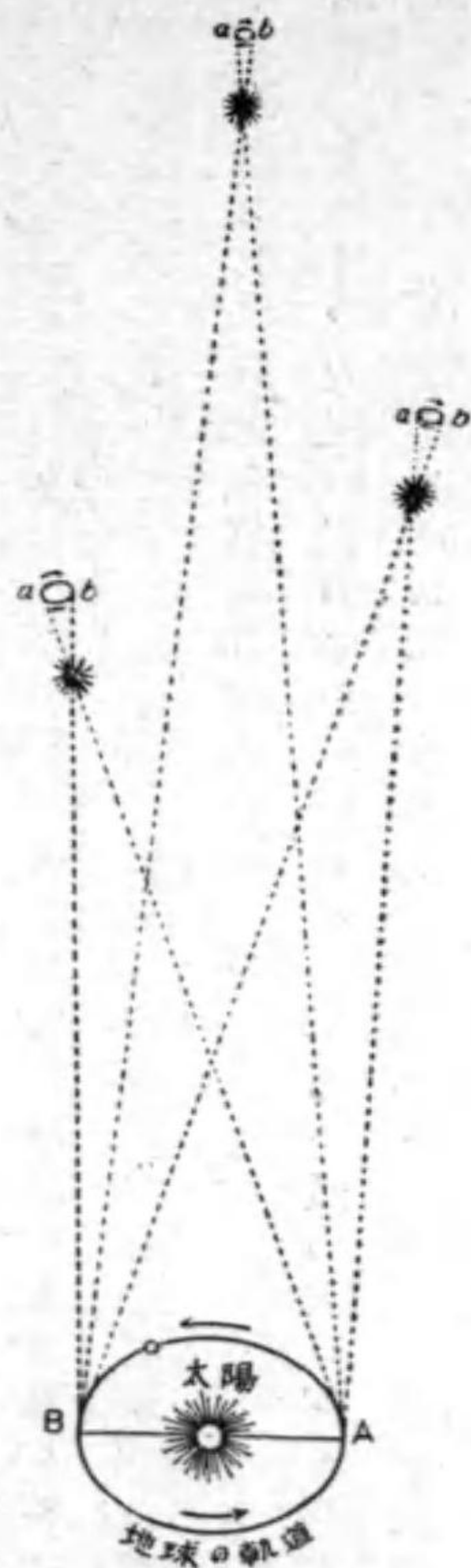
第43圖 星の視差 地球が軌道上Aにある時に星はaに見え、Bに來た時にはbに見える。
