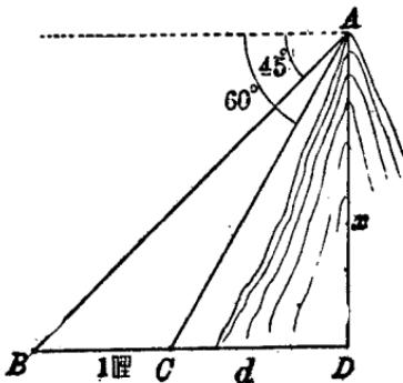
4. 一旗杆立於塔頂,在距塔100尺處,測得旗杆上下兩端之仰角各為 $45^\circ$ 及 $30^\circ$ . 問旗杆長幾何?
