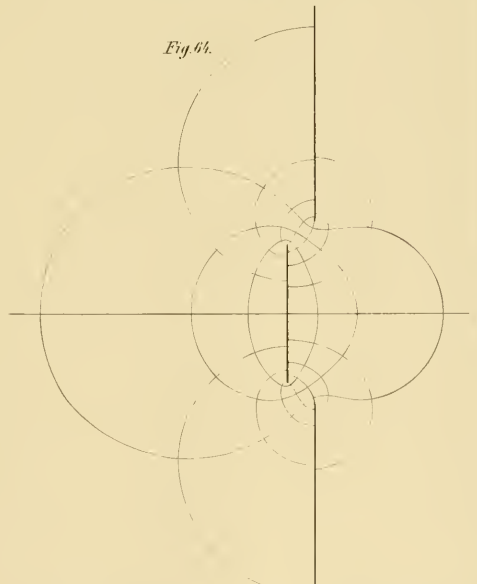
Abbildung eines Rechtecks mit den Seiten w_1 = \frac{\pi}{2} und 2a_2 = 2.71 auf eine unendliche Ebene durch die Function:
