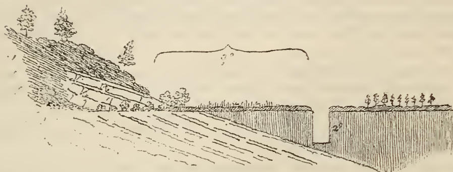
Figur 48. Steinbruch. Leitungscanal. Zwischen Stat. 45 und Stat. 46.
