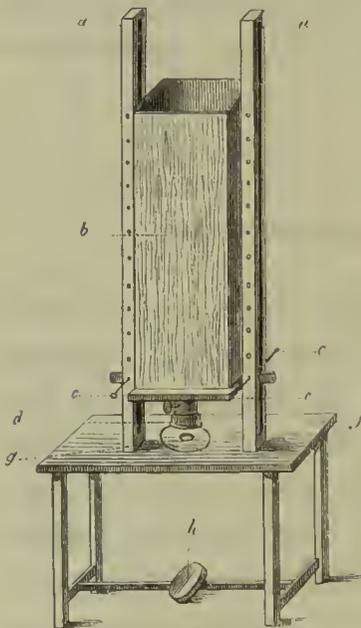
Fig. 5. Apparat für geringe Vergrößerungen.  $\frac{1}{19}$  der wirklichen Grösse
