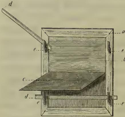
Fig. 9. Copirrahmen. *a*) Holzrahmen. *b*) Negativplatte. *c*) Durchschnitene Glassplatte. *dd*) Querbälkchen. *ee ee*) Klammern.
