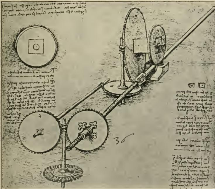
Walzwerk für Geschützdauben angetrieben von einer Turbine, um 1500.
