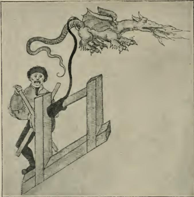
Militärischer Signalballon um 1540 mit Winde und Fesselseil. Der Drachenballon ist mit 2 Stabilisierungsflächen und Steuerschwanz versehen. Im Maul trägt er die — übertrieben gezeichnete — brennende Lampe zur Erhitzung der Luft im Innern. Nach einer Malerei in Codex german. fol. 94 der Königlichen Bibliothek zu Berlin.
