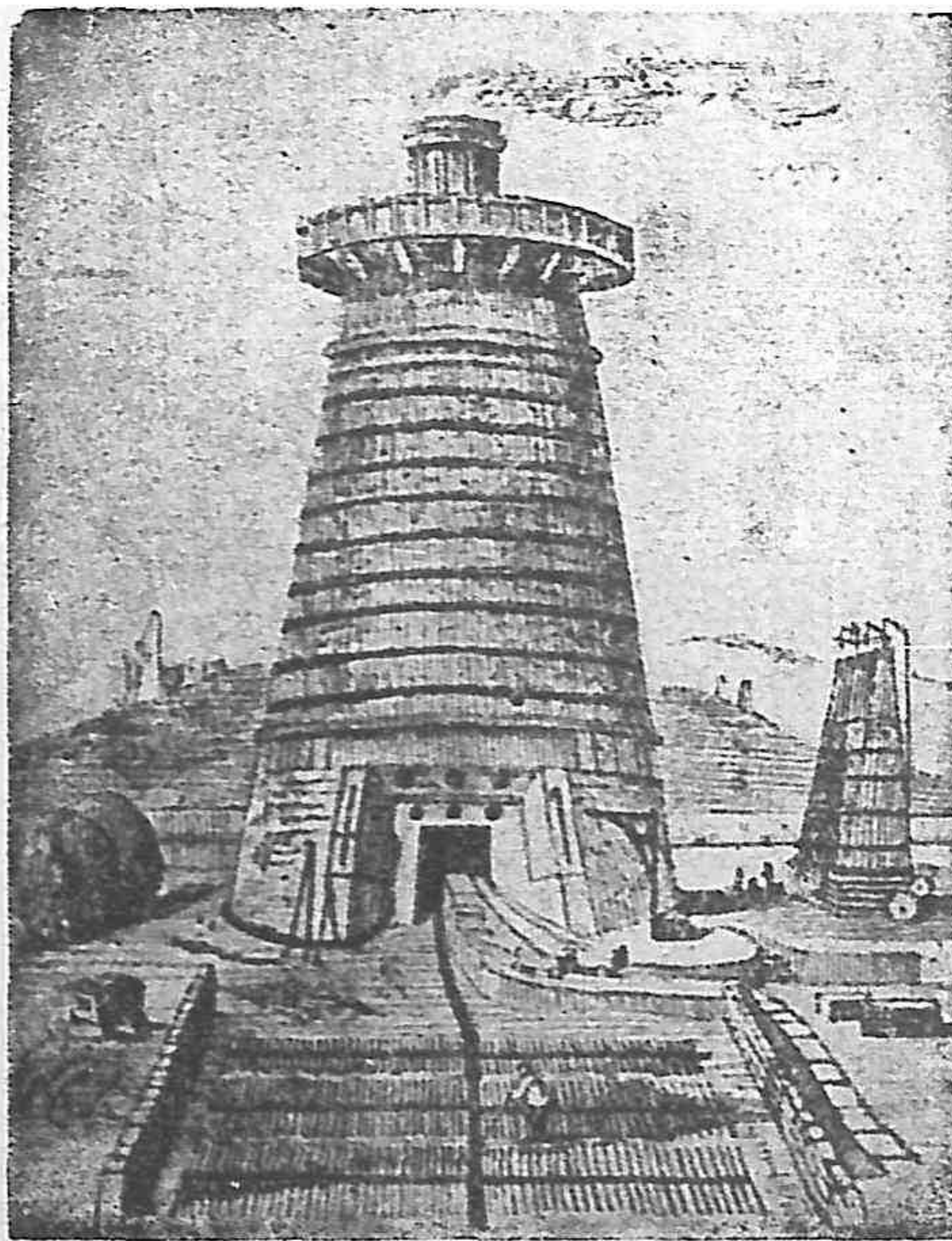
圖 10 十九世紀中葉之化鐵爐，前面爲銑鐵由爐內流至砂地之狀況。
