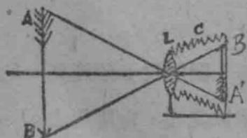
鏡（優良之攝影機則裝有數個之凸凹透鏡），使外來光線，經過透鏡在內壁生一顯明之實像，壁
