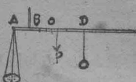
設空盤時，置錘於O，即可平衡，則以O爲秤星之起點，此時B之左方盤中之重力能率與B之右方PQ能率之和相等。
