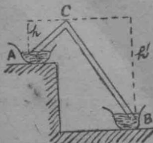
低處時用之，用時先盛滿液於管內，次將短臂插於高處之盛滿液體A器中，則液即由A器連續移入低處之B器，今設管之最高部C處為隔壁由左右兩臂作用於C
