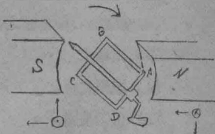
，順時針之方向轉動，當AB轉至N極時，依右手定則知電流取AB方向，同時CD內之電流取CD方向，
