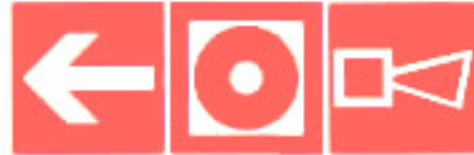
Пристрій ручного вмикання системи протипожежного захисту та звукового сповіщувача наліво
