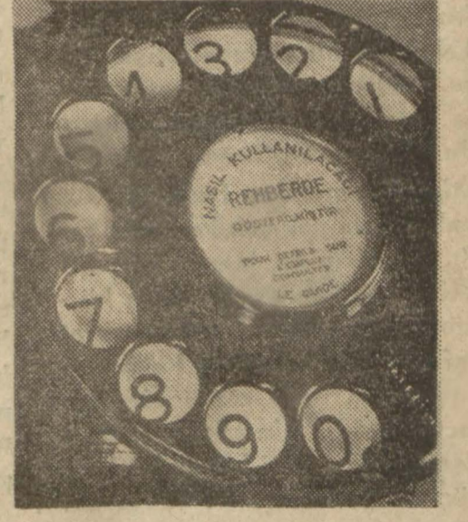
Otomatik telefonlarda numara kadranı ve Kadıköy'ünden başka on bir kü- çük merkez işlemektedir. Tesisat ta- mamile ikmal edildikten ve bu mer- kezler kaldırıldıktan sonra yalnız ist- tihbarat muhafaza ve hatalar bu- radan kontrol edilecektir.
