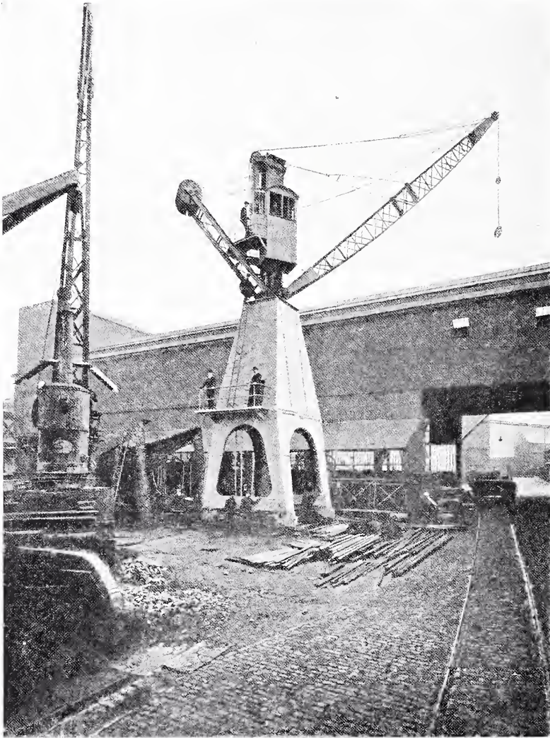
GRU IDRAULICA MOBILE A DOPPIA AZIONE A PORT DURBAN.
