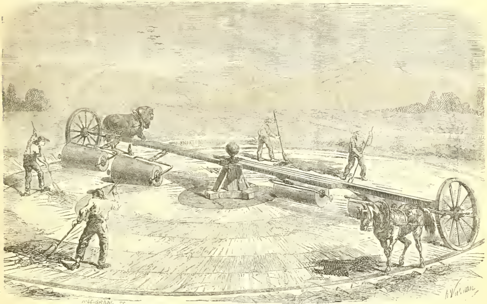
Fig. 126. — Rouleaux à manège pour l'égrenage des céréales (S. Villalongue).
