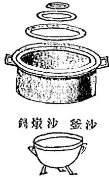
水釜分二層，上貯藥而下貯水，水沸與藥料之熱相宜則止，水沸不過百度，(百度表)乃水天然之性也，故藥類之熱，亦不過百度，製置物質膏藥類，常用此器。
