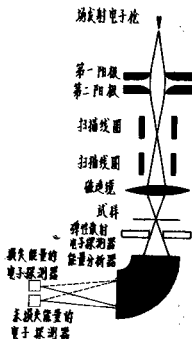
图 8-2 高分辨本领扫描电镜原理图
