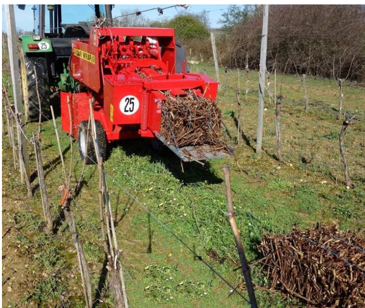
Рис. 8. Паковий прес-підбирач DW-V135 фірми DCMA DARIO
