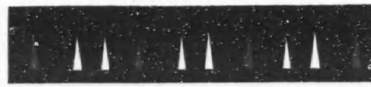
光 交 閃 連 ALTERNATING GROUP FLASHING
