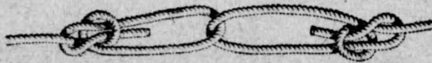
普通の網を一時的に結合するに用ふ。多くは極めて太きものに 用ひられる
