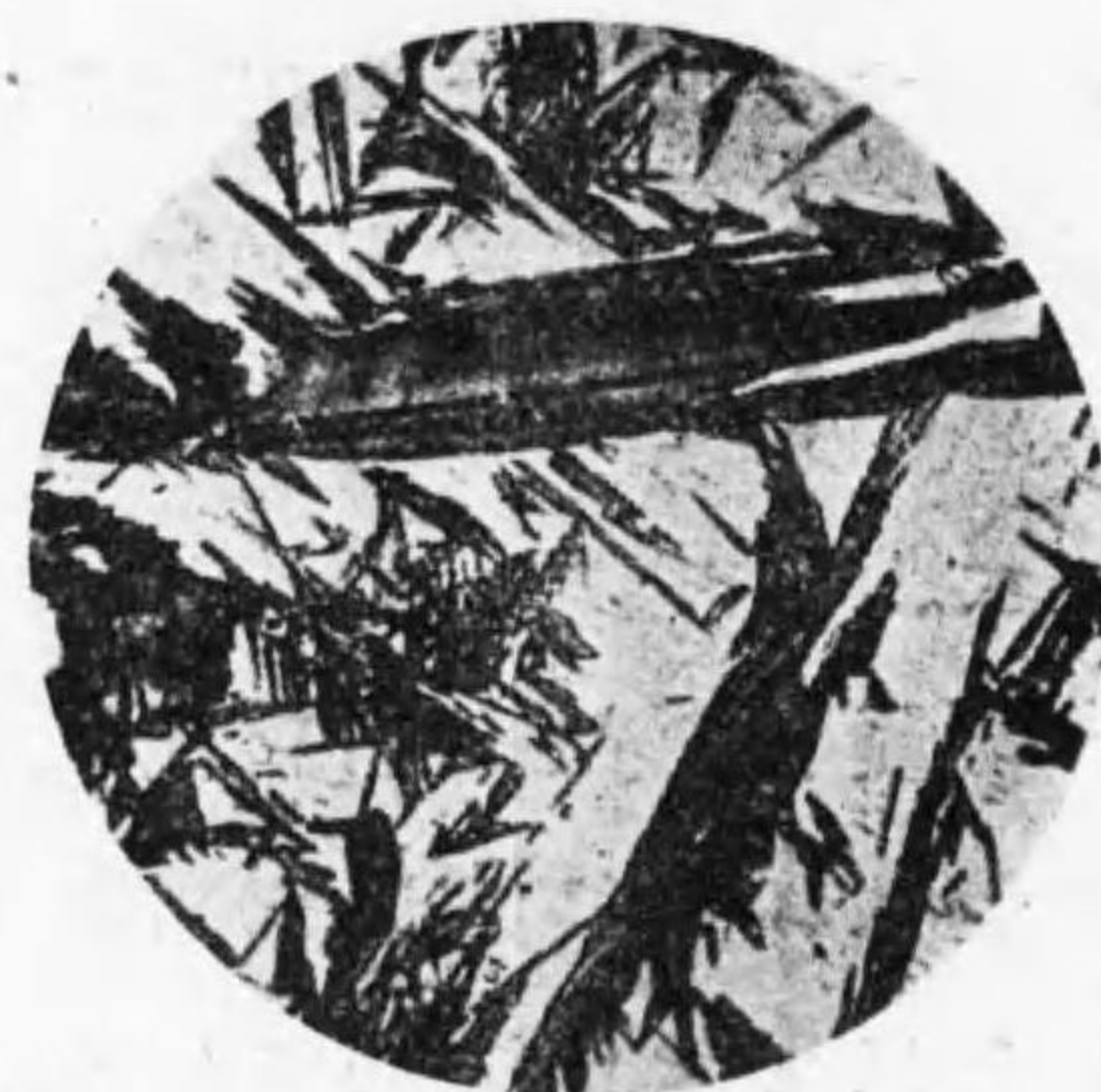
1.57% C (1000倍) 1,100°に加熱後水中冷却し再び150°に焼鈍。白色は大洲田、黑色針状は麻亞田
