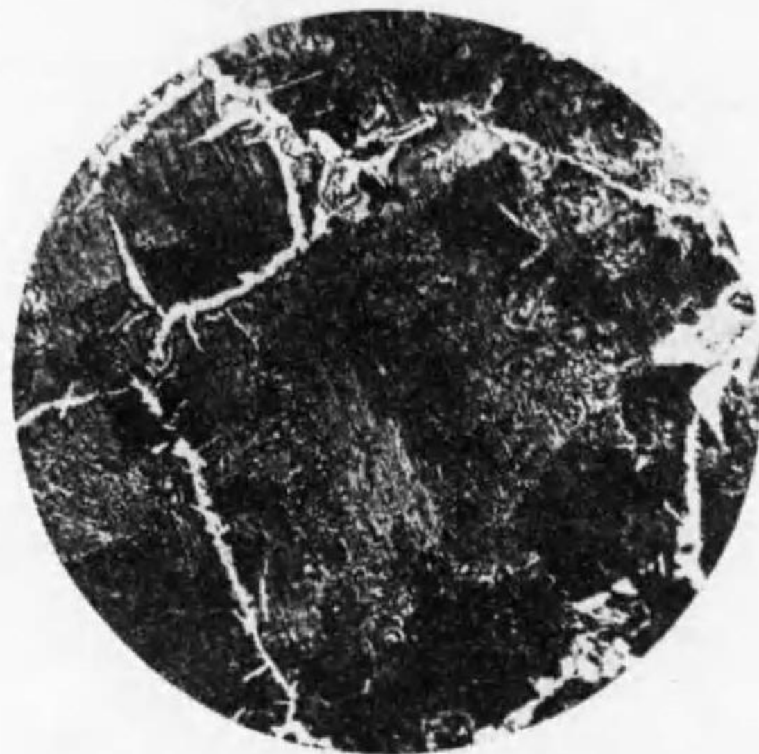
0.5% 炭素鋼 1100°C に加熱し空中冷却せるもの (150倍)
