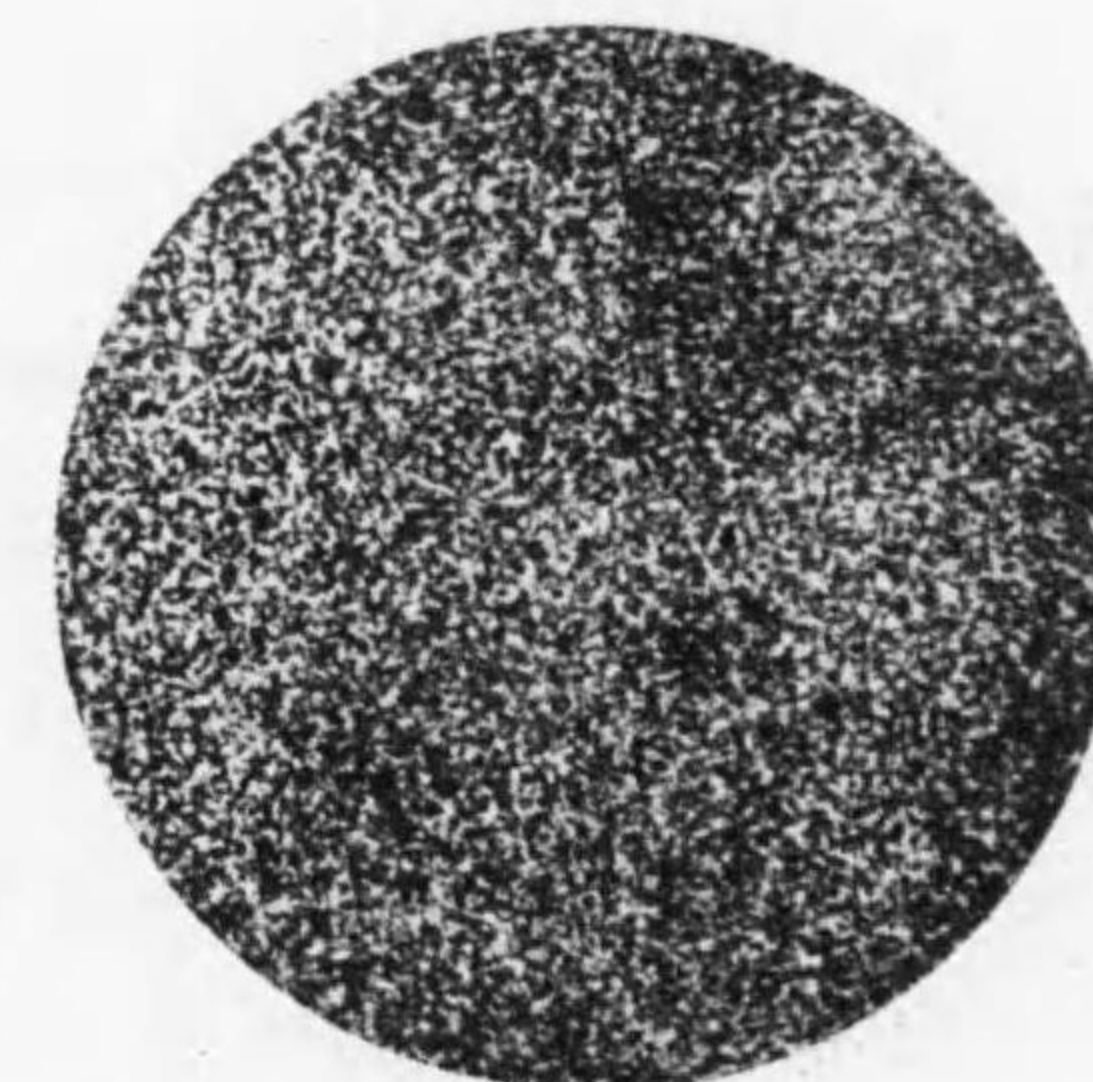
0.1% C 950°C に加熱し油中 冷却せるもの (180倍)
