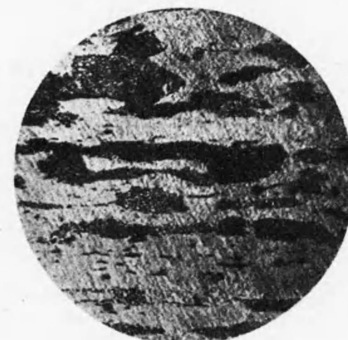
軟鋼線 冷間にて一回牽引 (0.27% C 330倍)
