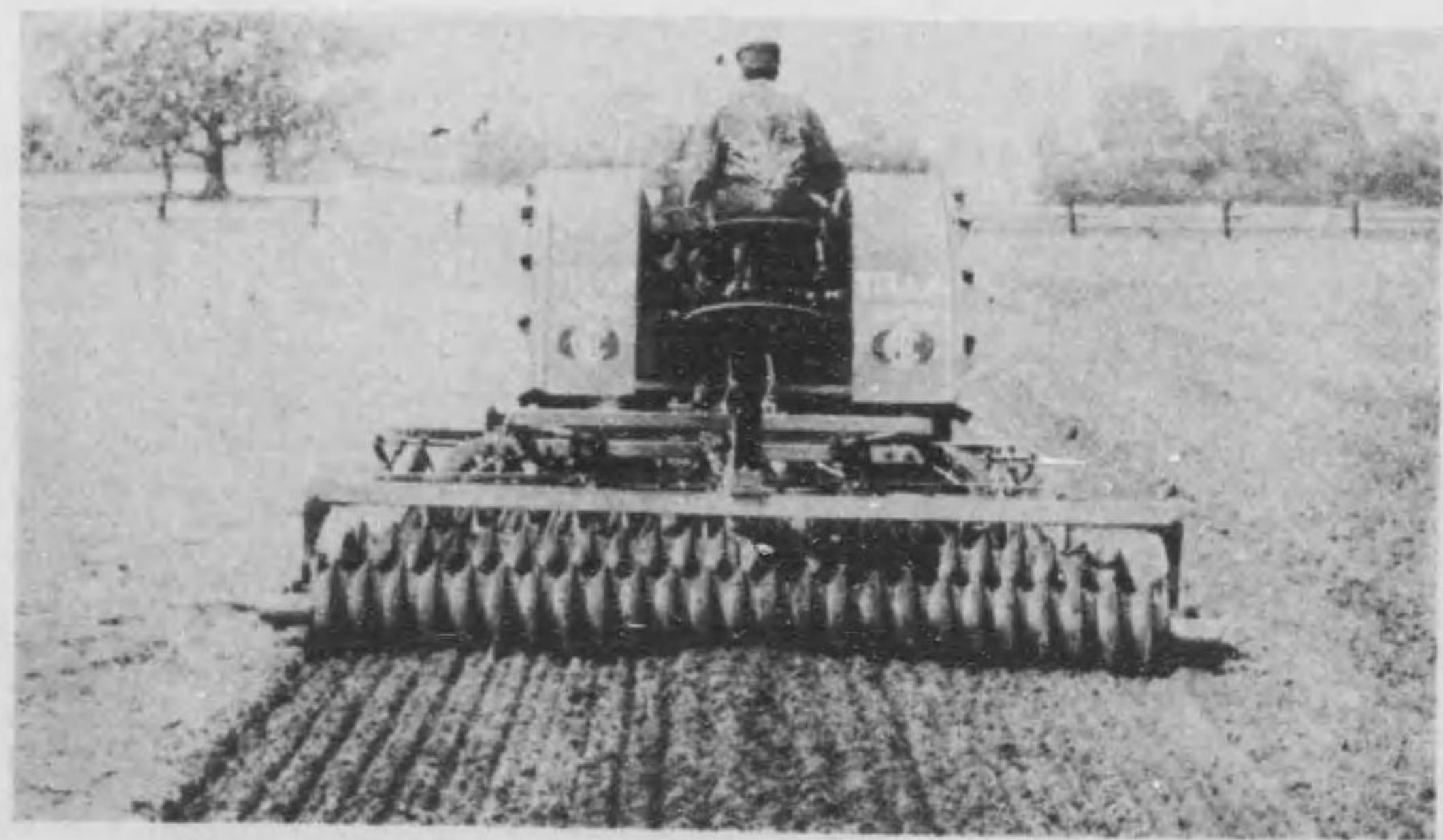
同上 (其八) パツカーを以て硬皮層を粉碎なすつゝある光景
