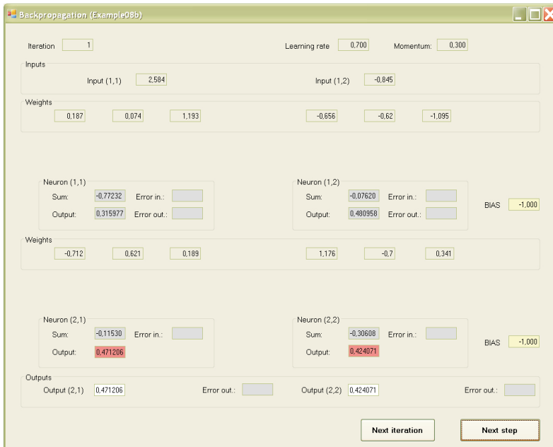
Rys. 7.14. Sieć po ukończeniu etapu propagacji w przód
