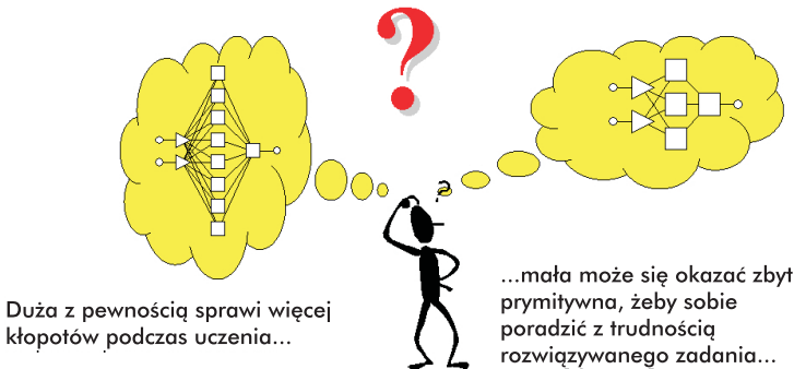
Rys. 2.40. Najbardziej istotny problem przy wyborze struktury sieci neuronowej wiąże się z ustaleniem, ile elementów powinna mieć warstwa ukryta?
