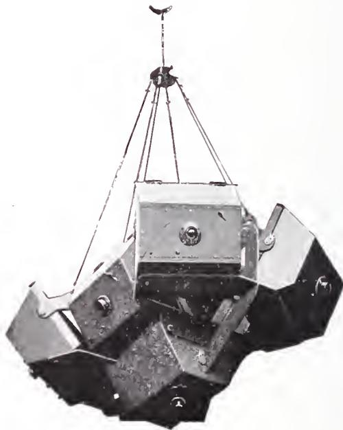
Auch in die Camera drang der Sand ein und war zeitweise für die Beweglichkeit des Verschlusses ein unangenehmes Hindernis, das nur mittels Hineinblasens und Anwendung eines Staubpinsels entfernt werden konnte.
