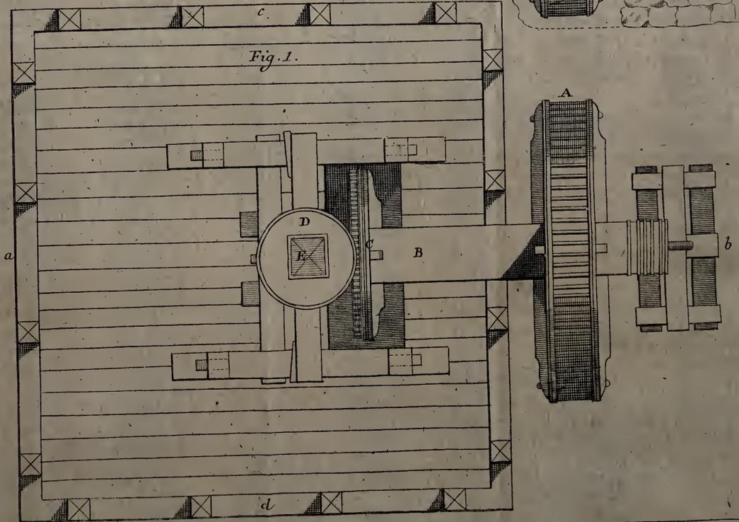
seyn kann, das mittlere Beschlüge ist mit 2 viereckichten Schraubenbändern befestiget, unter welchen Schraubenbändern auch 4 starke eiserne Schienen befestiget werden, die auf der Kante des Wellbaums, an beyden Seiten der eisernen Axe eingehauen sind, damit die eiserne Axe desto fester stehet.
