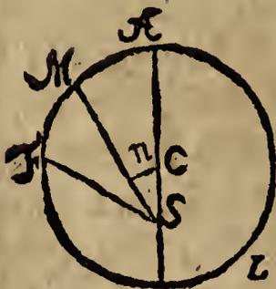
Die Figur A M L sey eine Ellipse, deren Excentricität  $C S = \lambda$  sehr klein ist. Die mittlere Weite  $F S = B$ ; M sey ein Punct im Umkreise, und C n senkrecht auf M S.
