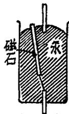
圖十六 磁石下端被線繫住，上端能繞通過電流之線旋轉。容器中盛汞，使電流能從底端的線通至上端。
