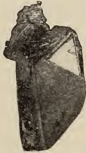
Fig. 4. Ein 0,7 mm messendes Graphitaggregat bei 40 maliger Vergrößerung.
