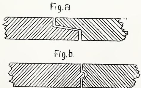
Die Art der Zusammenfügung der Röhrenwände bei den Stößen ist bei allen ausgestellten Exemplaren dieselbe, wie beistehende Figur a zeigt. Bei grossen Röhrenweiten wendet A. Favre auch die Stossverbindung Fig. b an. Die Fugen zwischen den Enden zweier Röh-
