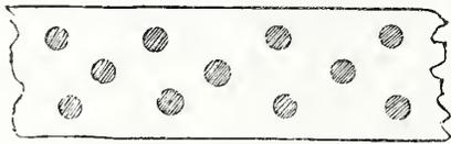
Die neue Tonhalle wird auf 2120 Pfählen von 0.25 m mittlern Durchmesser und 8.67 m mittlerer Länge stehen.
