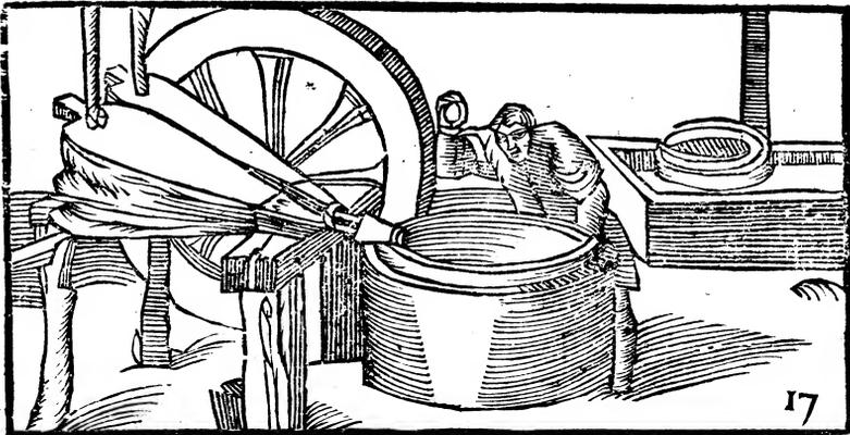
Les soufflets estoient posez au dessus du mur, & auoyent vne breche au mesme lieu, oules canons venoyët faire entree, de la hauteur d'vne brasses, & large d'vne & demie. Et sur les deux flancs estoit iointe à deux anneaux de fer vne grand' piece de bois, sur laquelle les soufflets estoient soustenus, tellement que facilement le vent par leur ayde estoit plus frequent. Vous aduertissant que
