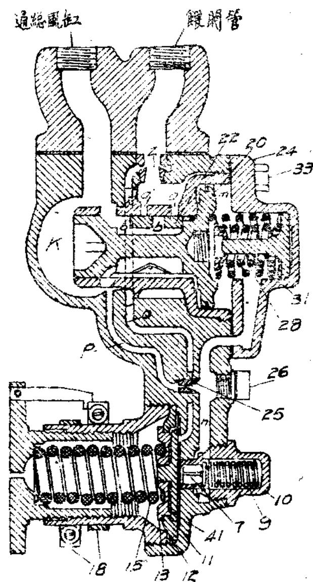
閥風管的壓力小；使調整彈簧15能完全開放調整閥7。因而輪20上面的風流出較快，壓力減低也快。若是經閥風管的風壓力，增加到差不多和所規定的數目相等時，則風在吹風嘴內流動的速度也減小。所以隔膜上面減低壓力的作用，也慢慢失去，使隔膜上面所受壓力增加，幫助調整彈簧嚴密時關閉調整閥。
