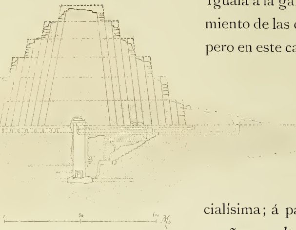
Fig. 258. — ESTRUCTURA DE LA PIRÁMIDE ESCALONADA DE SAKKARAH
