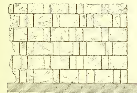
Figs. 631 y 632.—ALZADO Y PLANTA DEL REVESTIMIENTO DE LA FIGURA ANTERIOR EN LA PARTE BAJA DEL MURO
