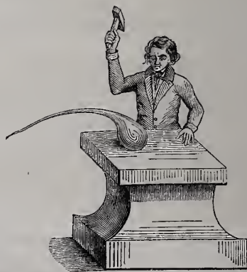
Fig. 3. Larme batavique résistante, par le gros bout, à des coups de marteau.
