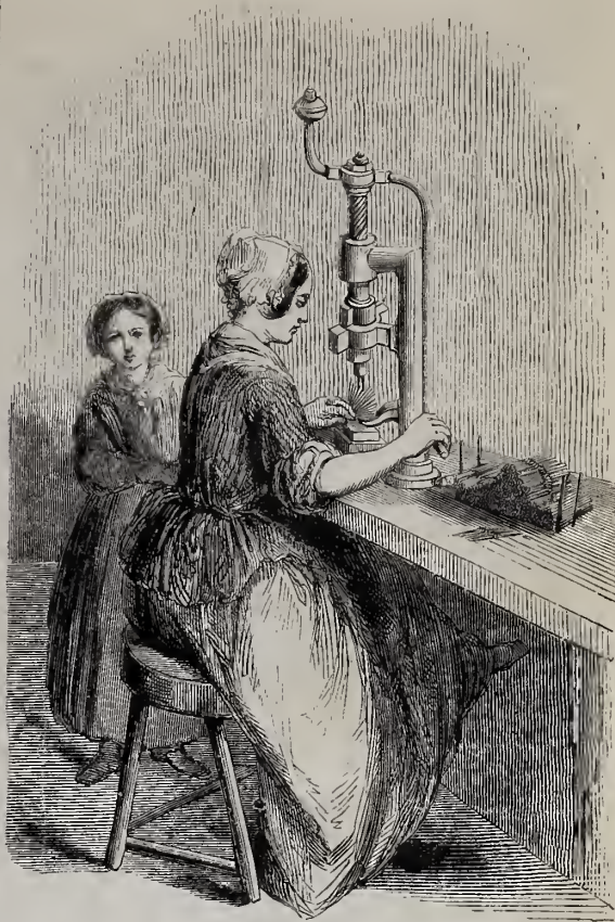
Fig. 5. Perçage ou formation du chas
