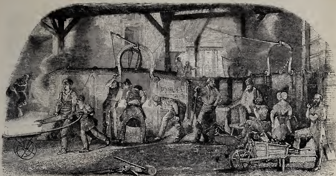
Fabrication du fer. — Fours à réchauffer les saumons de fonte.
