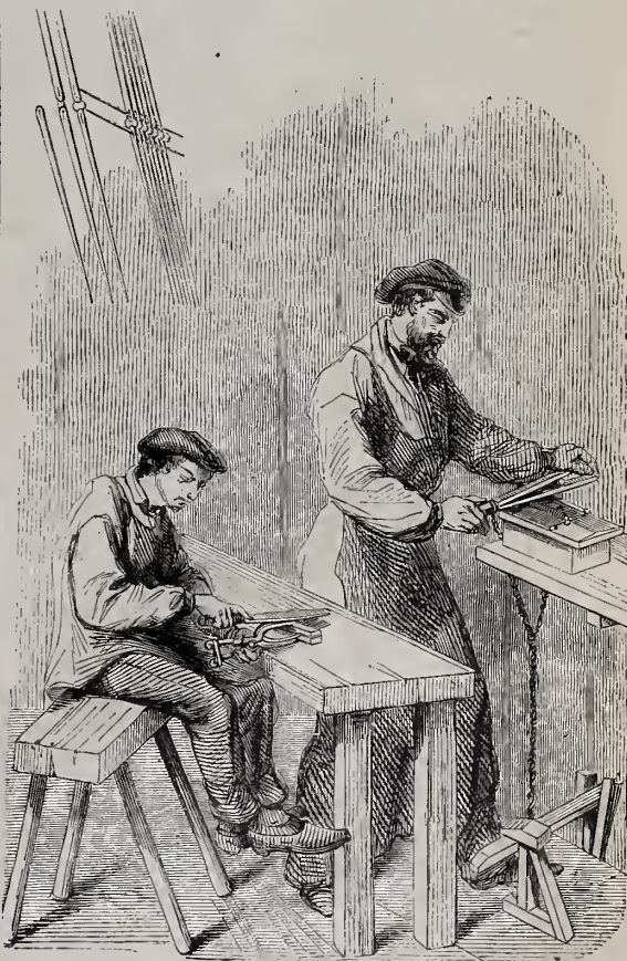
Fig. 6. Limage pour séparer les aiguilles nouvelles.
