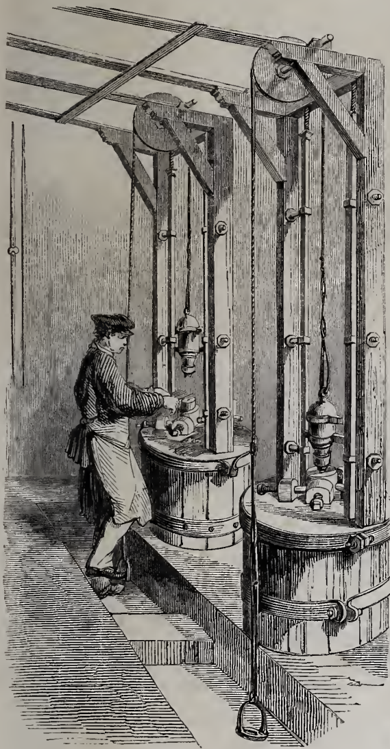
Fig. 4. Estampage des aiguilles jumelles avant leur séparation.
