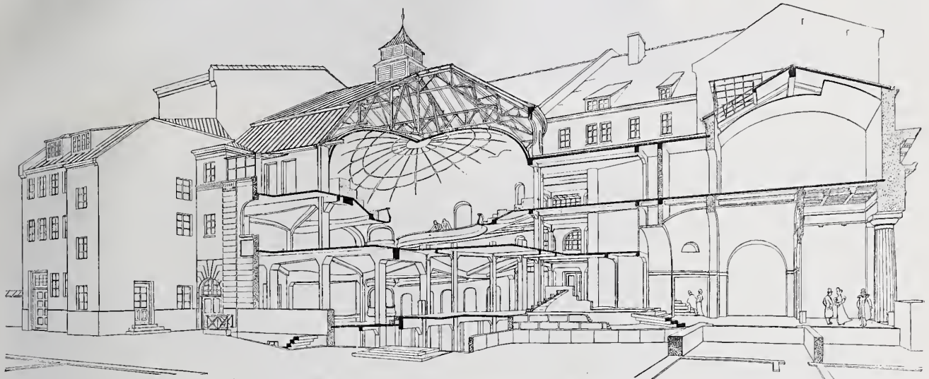
Abbildg. 2. Schnitt durch Vestibül und Zuschauerraum.
