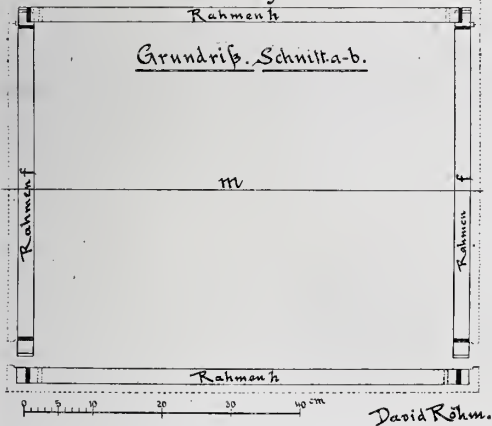
Röhm's zerlegbarer Ofenmantel aus Einzelwänden.
