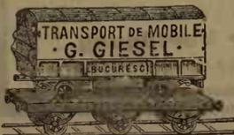
**Rollwagen für schwere Lasten**, für Dampfessel u. Maschinen bis zu 20.000 Kgr. in einem Stück
