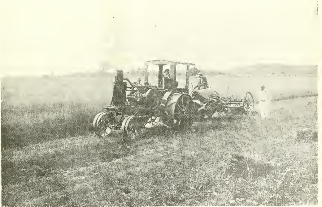
Fig. 77. — Tracteur Avery tirant une lieuse et un cultivateur canadien.
