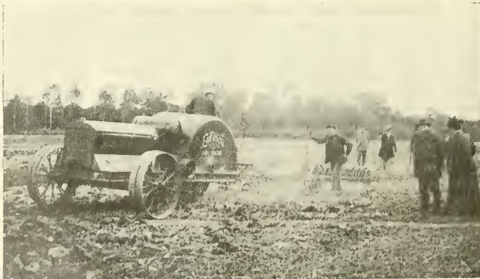
Fig. 54. - Traction d'un cultivateur, d'un rouleau brise-mottes et d'une herse par l'appareil Emerson.
