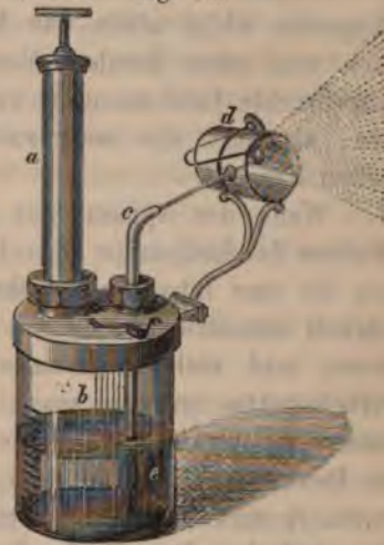
a. Luftpumpe. b. Graduirtes Glasgefäss. c. Glasröhre. d. Glascylinder. e. Medicamentöse Flüssigkeit.
