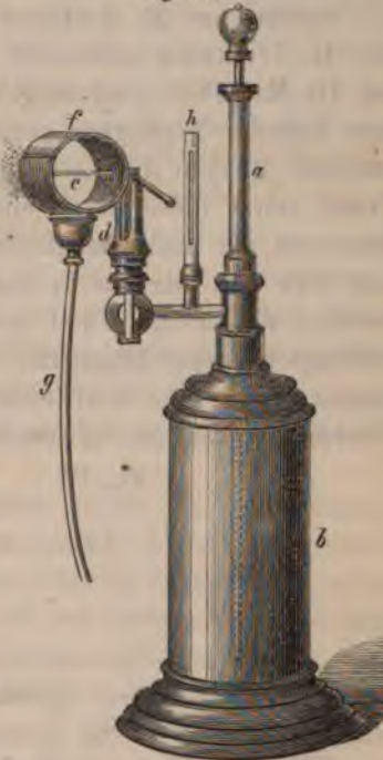
a. Luftpumpe. b. Glasgefäss. c. Metallknopf. d. Röhre. f. Cylinder. g. Gummischlauch. h. Manometer.
