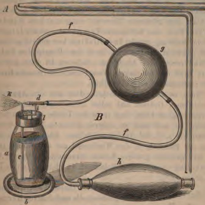
B. Bergson's Hydroconion zur Insufflation. a. Glasgefäss. b. Fuss desselben. c. Vertikale Glasröhre. d. Horizontale Glasröhre. f. Gummischlauch. g. Windkessel. h. Blasebalg. i. Befestigungsstab. k. Wasserstaub. l. Metallring. A. Modification der Glasröhren nach Prof. Winterich.
