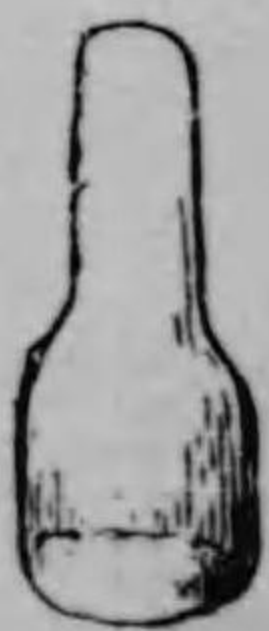
圖 六 第 [肉練棒] 六寸あり、重に塞水石にて製出す。上部の細き處を兩手にて握り、太き方を斜にして肉盤上にて煉肉に使用するものなり。
