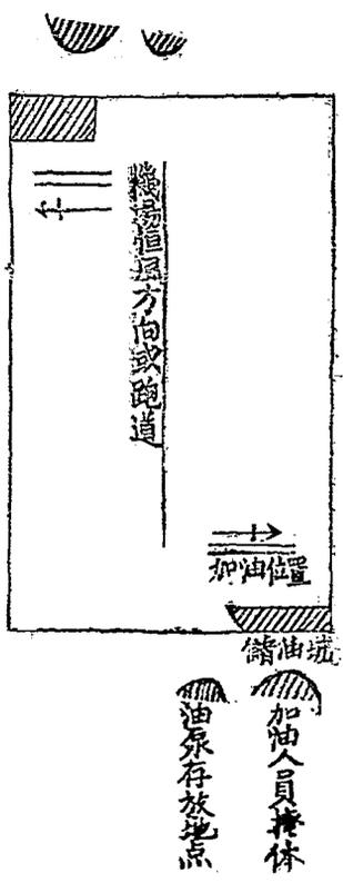
在機場恒風方向（或跑道）之兩端靠右方，指定加油位置，並在其邊沿挖油坑儲存油料，另在油坑後面設備防空掩體，以供加油人員休息之用，在掩體附近另設掩體，以供油泵存儲之用。
