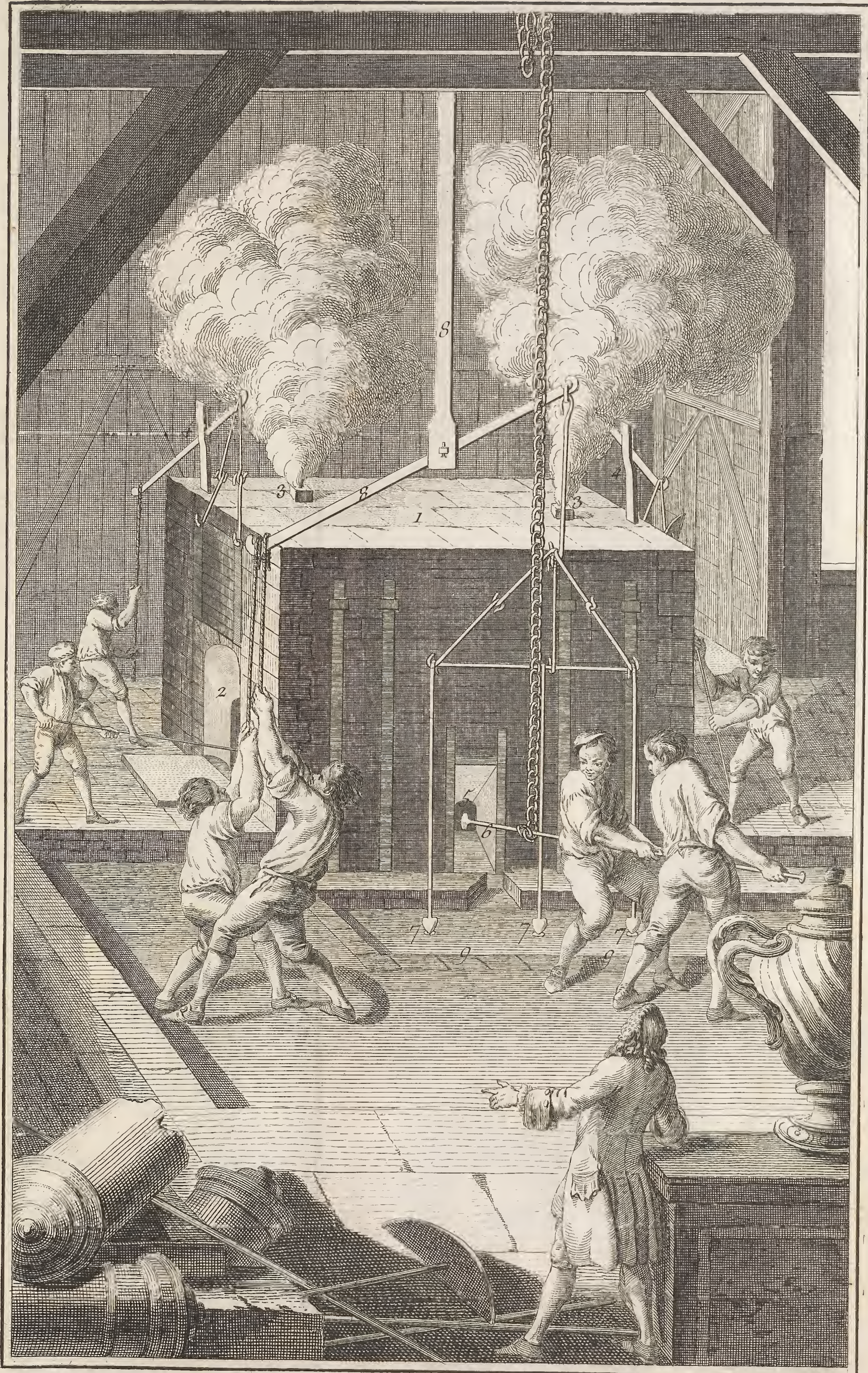
Sculpture, Fonte des Statues Equestres. Atelier de la Fonderie et l'opération de Couler la Figure en Bronze.
