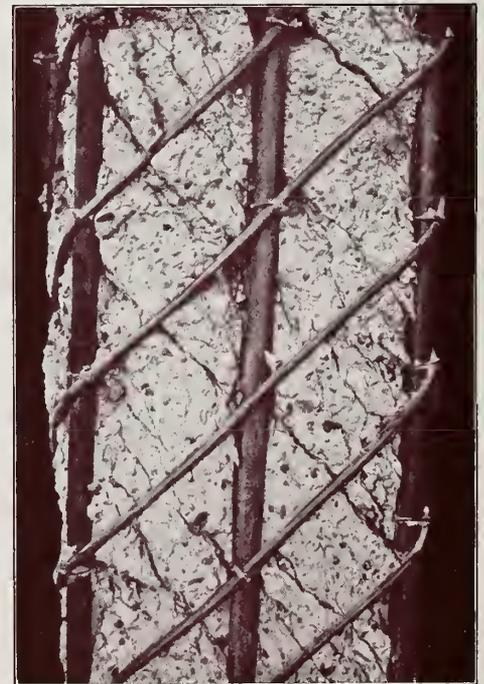
..... Widerstandsfähigkeit von Eisenbeton gegen Verdrehung. ....
