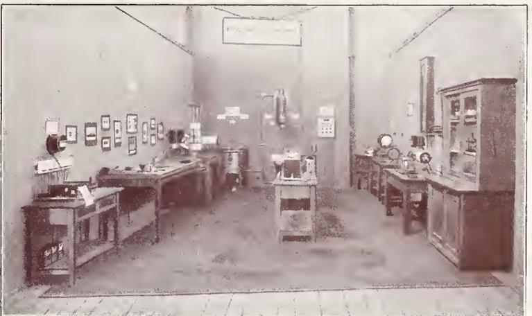
Abb. 9. Blick in das Metallographische Laboratorium. Einrichtungen zum Schleifen und Ätzen sowie für Schmelz- und Haltepunktsbestimmungen. ....
