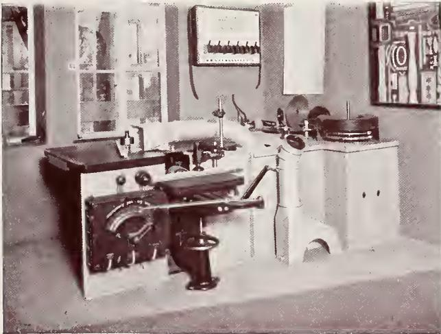
Späne- und Holzstaub-Absaugvorrichtung. Ausgestellt vom
