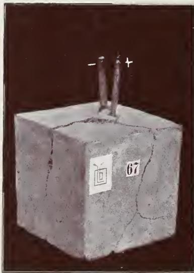
Einfluß der Elektrizität auf Eisenbeton.
