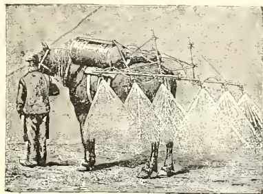
Fig. 69. — Pulvérisateur à traction Vermorel.)
