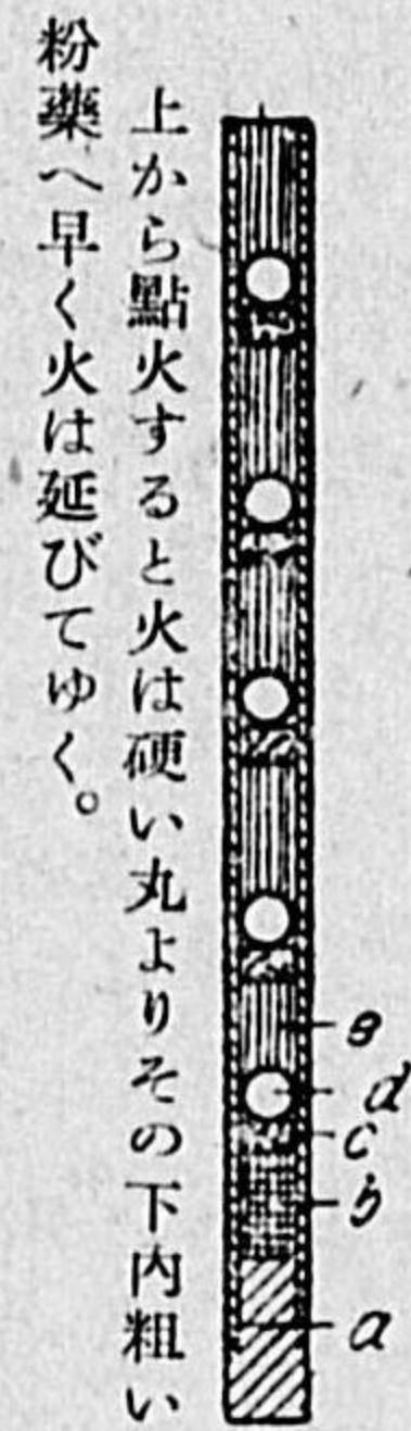
花火 五ツ玉、 a,b栓及び詰物、 cは打揚火薬。 dは置玉。 上より點火され次第に下のものを吹出す。
