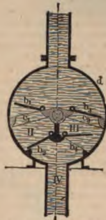
5. Крыльчатый насос (разрядный).
