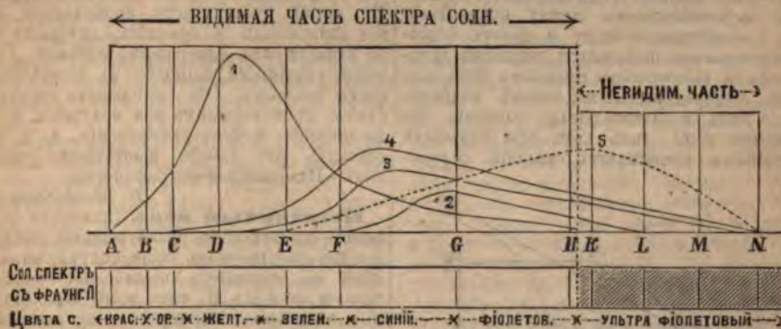
Фиг. 2. Кривая 1—впечатлѣніе свѣта на глазъ. Кривая 2—дѣйствіе свѣта на іодистое серебро. Кривая 3—тоже на бронзовое серебро. Кривая 4—тоже на смѣсь бронзоваго и іодистаго серебра. Кривая 5—тоже на хаористое серебро.
