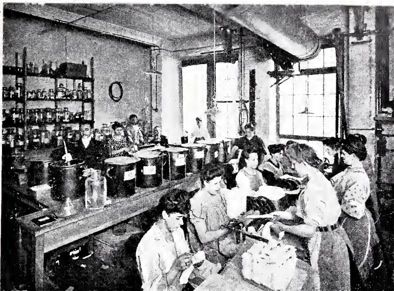
IL TESSUTO DELLE RETICELLE IMBEVUTO DAI NITRATI.
