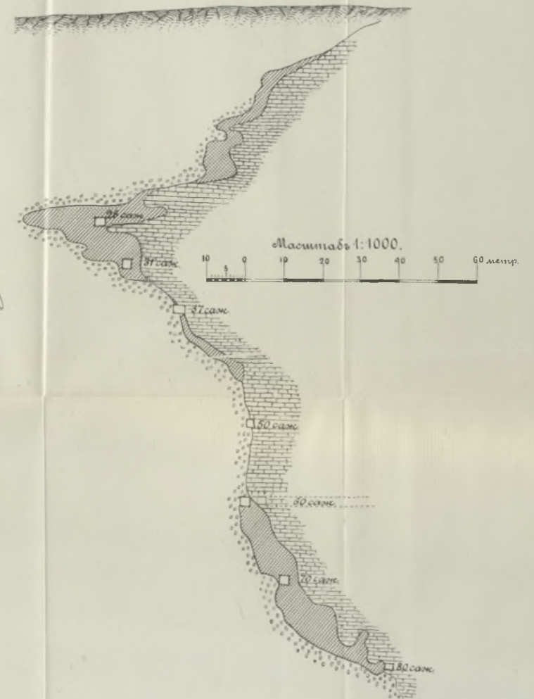
Вертикальный разрезъ Фроловскаго мѣднаго рудника. Фиг. 9.
