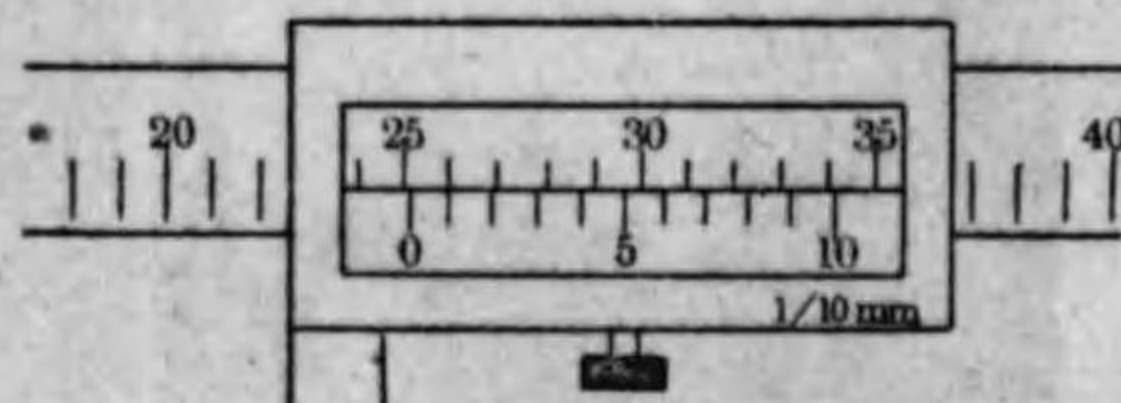
第199圖 メートル式ノギスの讀方
