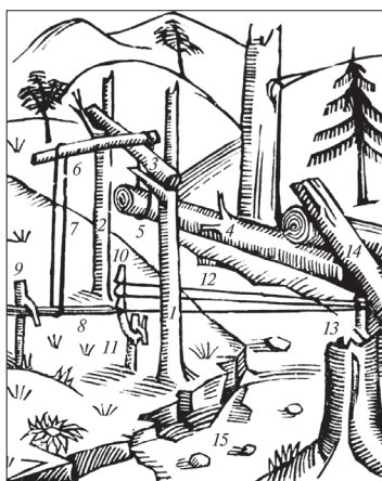
Сліп на ведмеда чи вовка: 1—2 — сохи; 3 — кладина; 4 — криж; 5 — гужевка; 6 — важок; 7 — гужевка; 8 — язик; 9 — клока; 10—11 — ключки; 12 — нитки; 13 — палик; 14 — киск, або терьх; 15 — плай. За М. Глушком.
