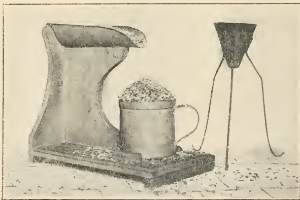
Fig. 89. — Appareil pour la détermination du poids de l'unité de volume de matière.
