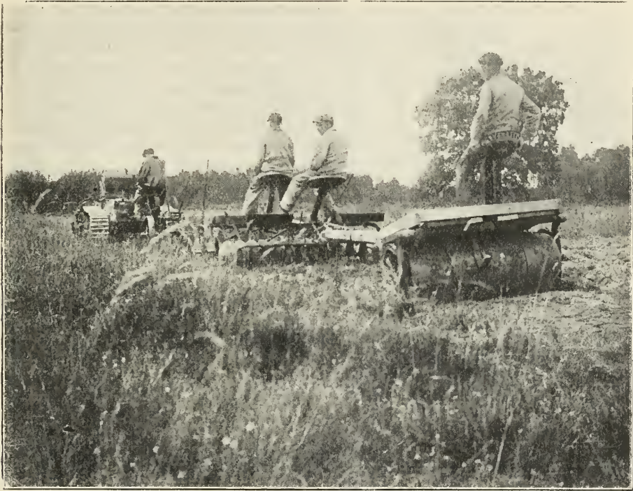
Fig. 43. — Tracteur Renault attelé à une série d'appareils dont un seul passage fait disparaître toute trace de végétation.
