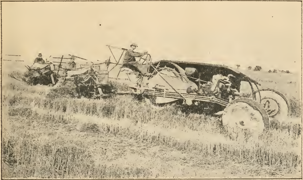
Fig. 19. — Récolte du riz au tracteur Gray tirant deux moissonneuses-lieuses.
