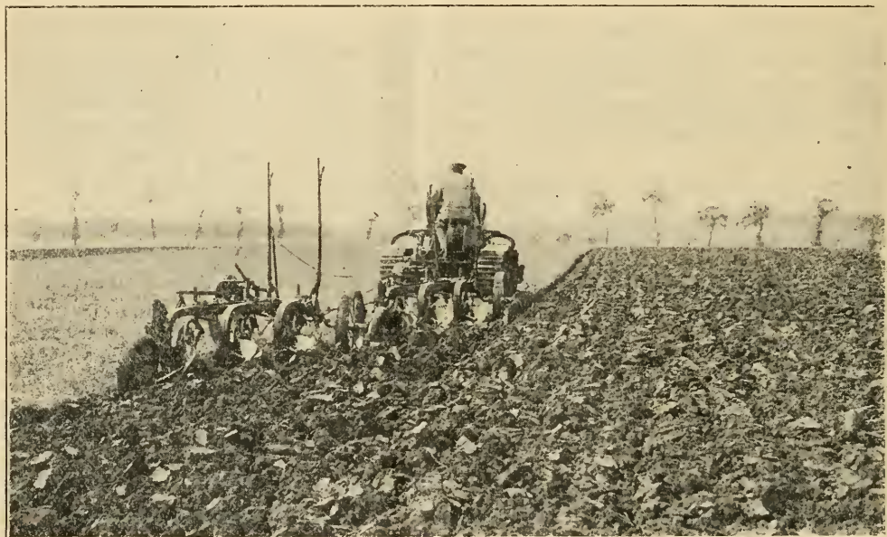
Fig. 48. — Nouveau tracteur Renault (type II I) attelé à une forte charrue à trois raies.
