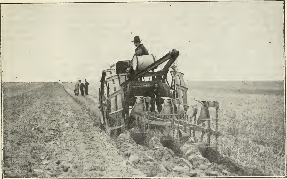
Fig. 53. — Charrue automobile de H. Amiot, dite Gerbe d'Or .
