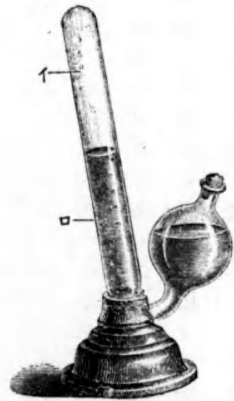
一八八圖 キューネ氏醱酵器 (イ)炭酸瓦斯、(ロ)醱酵原液 (原圖)
