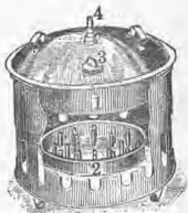
第216圖 弗劉格氏裝置 經過5.孔(有螺絲蓋)向容器1.中倒水和弗爾馬林；4.排氣孔；3.酒精燈(圖上裝置的前側壁已除去)。
