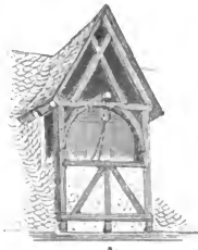
Fig. 14 u. 15. Spitze von Binnlufen. a. Binnlufen. b. Außen.
