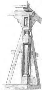
Fig. 5. Detail. Ausbildung eines Eckpfostens.
