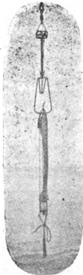
Рис. 4. Замыкающаяся пелагическая сѣть при спускѣ.
